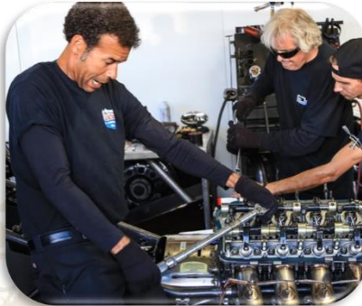
Fig. 7. La llave de torsión es una herramienta que permite conocer la cantidad de torque aplicado. Photo by Glenn Hansen on Unsplash
