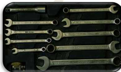
Fig. 6. La capacidad para producir momento depende de la fuerza y de la distancia; una llave más larga, tendrá mayor brazo de palanca y por tanto mayor capacidad para producir torque. Photo by Elena Mozhilo on Unsplash
